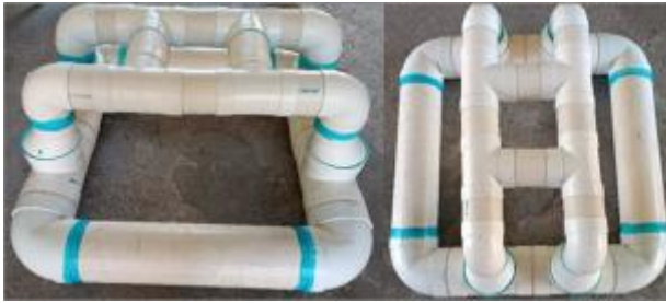
Fig. 5 Armado de la base con PVC
